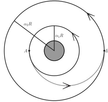
Dazu erfolgt eine erste Bahnkorrektur im Punkt  $A$ , typischerweise durch eine Oberstufe der Trägerrakete. Die Bahn wird aufgeweitet auf die gestrichelt gezeichnete Verbindungsbahn, die der halbe Bogen einer Kepler-Ellipse ist, deren einer Brennpunkt im Zentrum der Erde und der Kreisbahnen liegt und deren große Halbachse halb so groß ist wie die Entfernung zwischen  $A$  und  $B$ .
