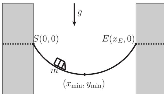
Unter der Kaiserstraße wird ein Tunnel für die Straßenbahn gegraben. Dabei ist die einfachste Möglichkeit, eine horizontale Verbindung zwischen zwei Haltestellen, nicht die idealste. Durch eine leicht nach unten gekrümmte Bahn lässt sich die Gravitation hilfreich ausnutzen. Bei der Ausfahrt aus der Haltestelle wirkt eine zusätzliche Beschleunigung auf die Bahn, während bei der Einfahrt in die nächste Haltestelle die nach oben ansteigende Strecke zusätzlich bremst.
