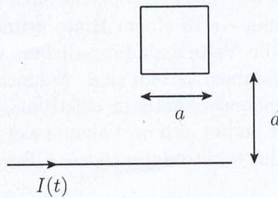
Abbildung 4: Ein unendlich langer Draht und eine quadratische Drahtschleife.
