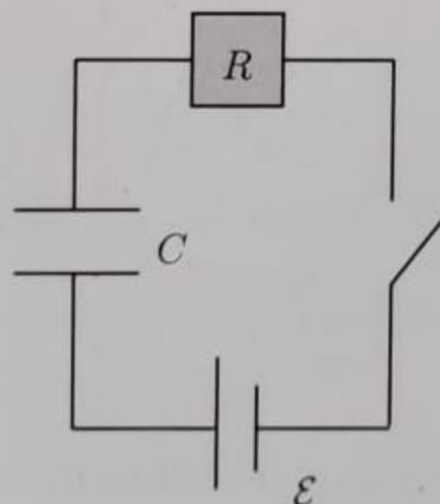
Abbildung 2: RC Stromkreis: Reihenschaltung eines Kondensators  $C$  mit einem Widerstand  $R$  und einer Batterie.
