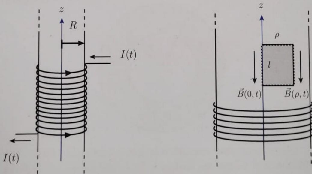
Abbildung 5: Unendlich lange Spule mit Windungszahl  $n$ , Radius  $R$  und Strom  $I(t)$  (links) mit rechteckiger Ampère'scher Schleife der Höhe  $l$  und Breite  $\rho < R$  für Aufgaben (c) und (d) (rechts). Die abgebildete Richtung von  $\vec{B}$  gilt für  $\omega t \in [0, \pi/2]$ .
