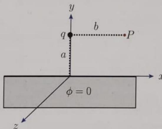
Abbildung 1: Eine Punktladung  $q$  befindet sich eine Distanz  $a$  oberhalb eines unendlichen Leiters, mit  $P = (b, a, 0)$ .
