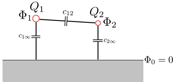
Nun wird offensichtlich, dass sich die Lösung der Aufgabe auch alternativ mit Hilfe des Schaltkreises der Kapazitäten berechnen ließe: Kapazitäten  $c_{1\infty}$  und  $c_{2\infty}$  sind in Reihe zueinander und parallel zu  $c_{12}$  geschaltet. Es folgt für die Kapazität  $C = \frac{Q}{\Phi_1 - \Phi_2}$
