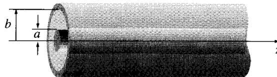
In dieser Aufgabe betrachten wir ausschließlich die TEM-Wellen in einem unendlich in  $z$ -Richtung ausgedehnten Koaxialkabel. Benutzen Sie den Ansatz  $\mathbf{E} = \mathbf{E}_0(x, y)e^{i(kz - \omega t)}$ ,  $\mathbf{B} = \mathbf{B}_0(x, y)e^{i(kz - \omega t)}$  mit  $E_{0z} = 0$  und  $B_{0z} = 0$ .
