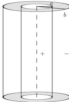
Abbildung 1: Ein koaxiales Kabel.
