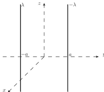
Abbildung 1: Zwei unendlich lange parallele Drähte in der  $y$ - $z$ -Ebene, die jeweils eine Distanz  $\pm a$  von der  $z$ -Achse entlang der  $y$ -Achse entfernt sind und eine Ladungsdichte  $\mp\lambda$  aufweisen.
