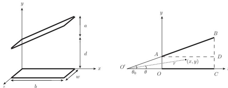
Abbildung 2: Kondensator mit ebenen Platten. Die untere Platte liegt in der  $x$ - $z$ -Ebene. Die obige Platte ist orthogonal zur  $x$ - $y$ -Ebene und um einen Winkel  $\theta_0$  relativ zur unteren Platte gedreht. Die Platten haben eine rechteckige Form mit Länge  $b$  und Breite  $w$ .
