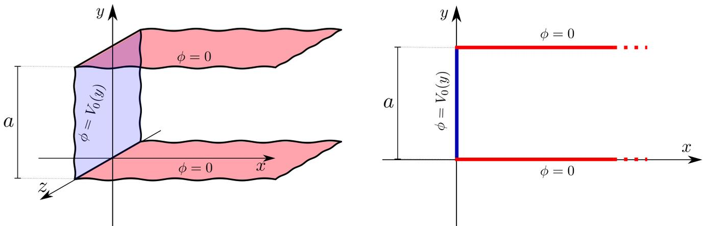
Das Potential zwischen den beiden parallelen Ebenen soll bestimmt werden.
