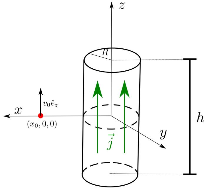
Figure 2: Zylinder mit Stromfluss  $\vec{J}$  und Testladung  $q$  an der Position  $\vec{r} = x_0 \hat{e}_x$  und Geschwindigkeit  $v_0 \hat{e}_z$ .
