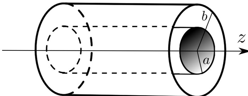
Gegeben sei ein Koaxialkabel mit dem inneren Radius  $a$  und dem äußeren Radius  $b$ , wie in der Abbildung oben zu sehen. Sie können, wie üblich, das Kabel als unendlich lang nähern. Damit ergibt sich als mögliche Lösung der Wellengleichung zwischen den beiden Oberflächen
