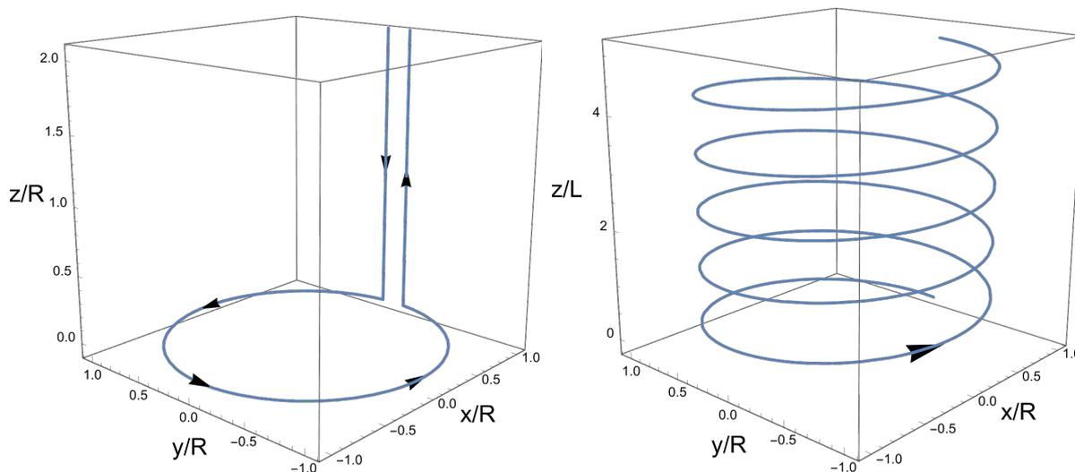
Ein metallener Draht (blaue Linie) ist zu einer Leiterschleife (links) oder einer Spule (rechts) gewickelt. Die schwarzen Pfeile deuten die Orientierung der Stromdichte  $\mathbf{j}(\mathbf{r})$  an.
