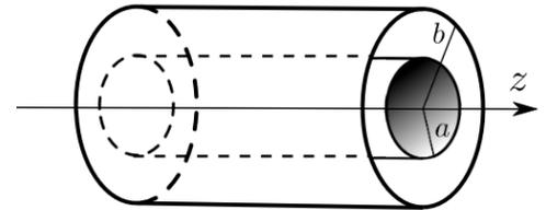
Betrachten Sie ein Koaxialkabel, siehe Abbildung, auch bekannt aus Blatt 6 Aufgabe 2. Das Kabel besteht aus zwei koaxial angeordneten Leitern: Einem leitenden Draht im Zentrum mit Radius  $a$  und, mit Radius  $b$ , einem weiteren Leiter in Form einer leitenden Zylinderhülle. Das Koaxialkabel wird als unendlich lang angenommen.
