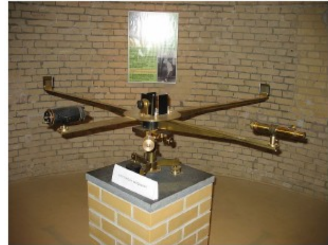
Originalgetreuer Nachbau eines Michelson-Interferometers. [wiki]
