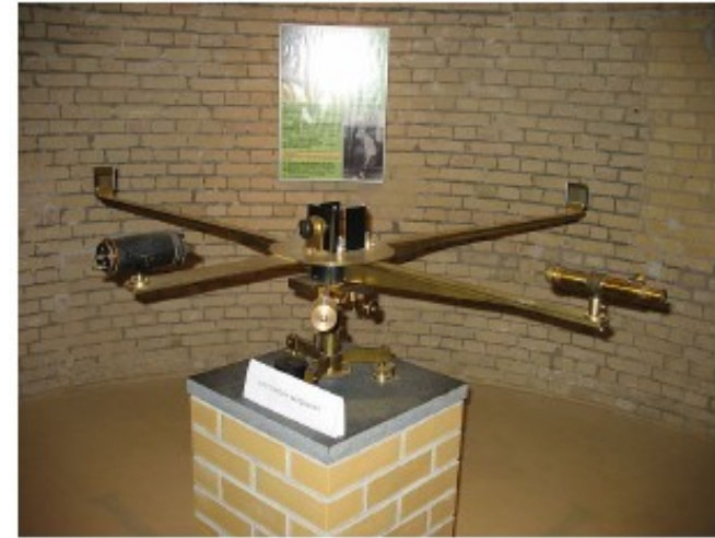
Originalgetreuer Nachbau eines Michelson-Interferometers. [wiki]
