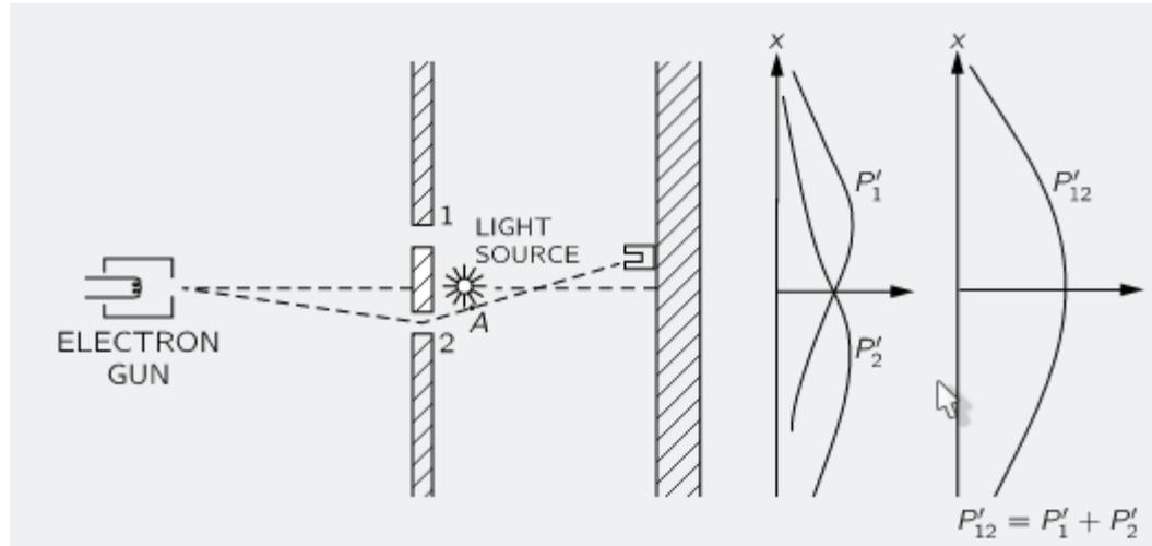
Eine Lichtquelle beleuchtet den Spalt im Doppelspaltexperiment mit Elektronen;
