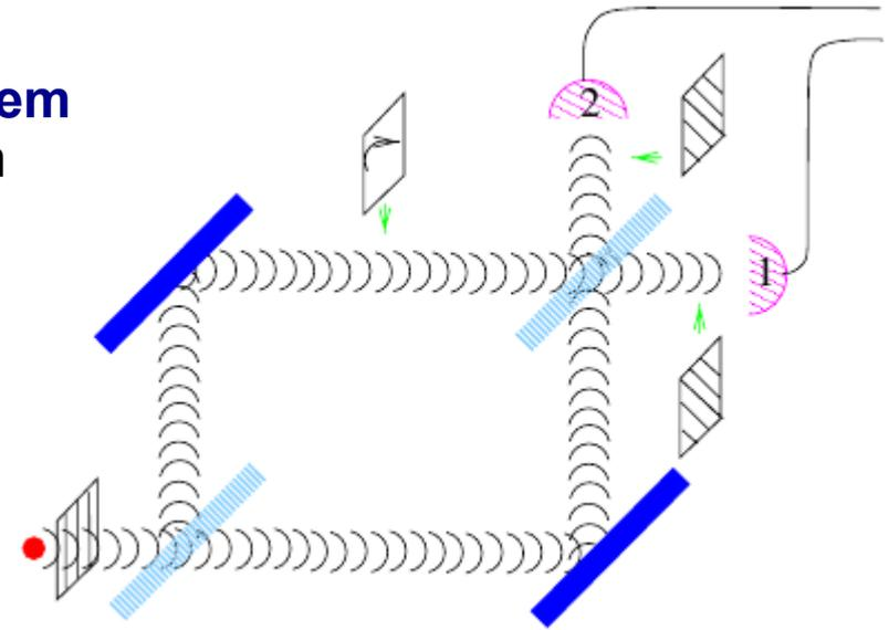
Mach-Zehnder Interferometer mit **polarisiertem Licht & Polarisations-Rotator** in einem Arm
